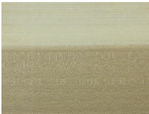
図1 ホオノキの材面(柾目) 軽軟で加工が容易であり、器具材などに使われる
