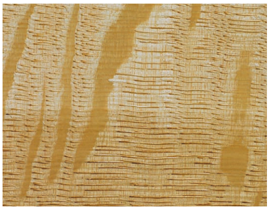
図1 ミズナラの材面(柁目) 大きな放射組織が柁目面で虎斑となって現れる
