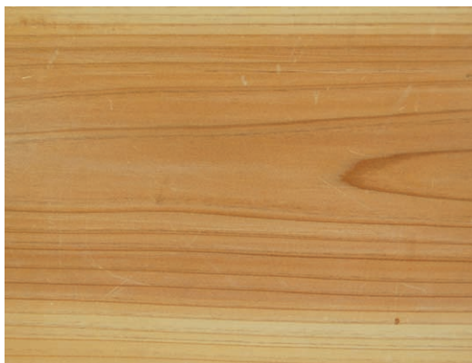
図1 スギの材面(板目) 木目が通直で割りやすく、軽量で加工も容易で古来より多様な用途に用いられる
