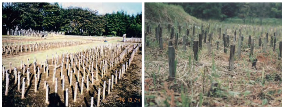
野外防腐効力試験現場(左:茨城県つくば、右:奈良県明日香) キトサン銅錯体処理材の防腐試験は奈良県明日香において実施された (酒井温子ほか、木材保存 43(3)、2017)
