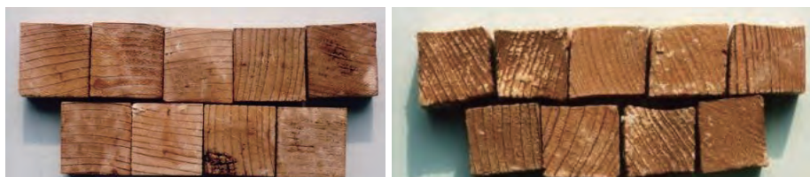
室内防腐試験後の試験片(左:キトサン銅錯体処理、右:無処理)
