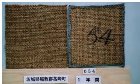
キトサン銅錯体処理ジュート麻の屋外腐朽試験の結果(試験開始1年目)(茨城県) 左:処理区、右:無処理区(それぞれ左側は試験前の試験材)
