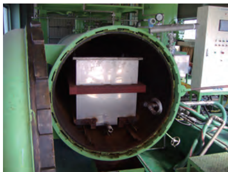
空気圧式注入試験現場(左：加圧注入装置、右：注入作業準備)
