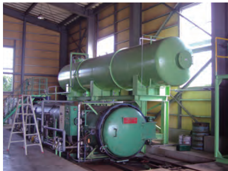
液圧式注入試験現場(左：加圧注入装置、右：注入作業準備)
