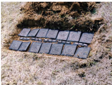
掘った穴の中に試験材を並べる 表面を平滑にならす
