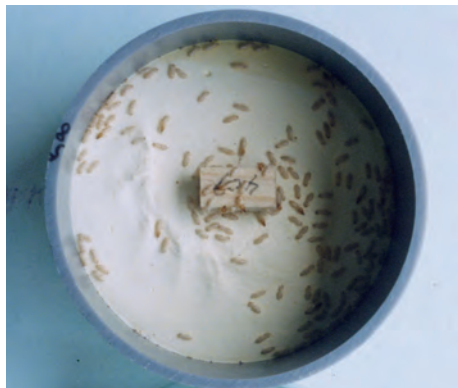
室内防蟻効力試験 (左：試験状況、右上：無処理、右下：キトサン銅錯体処理)
