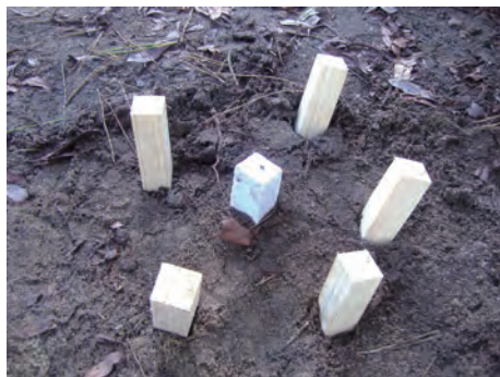
中央がキトサン銅錯体処理試験体、 周囲の5本は無処理試験体(誘蟻木)
