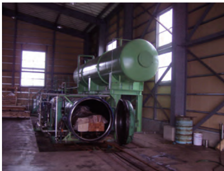
液圧式注入試験現場(左：加圧注入装置、右：注入作業準備)
