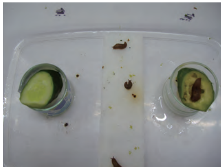
キトサン銅錯体含侵テープの効果 左：テープを巻き付けてある 右：何もしていない
