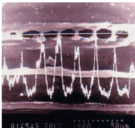
キトサン銅錯体は放射線細胞壁に局在していた (スギ)
