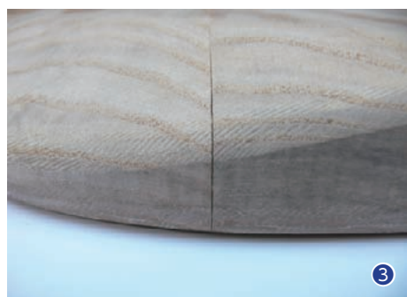
1979年製コンター部ピース剥がれ
