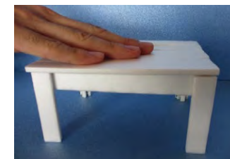
図3 模型製作による机の強度テストの例
