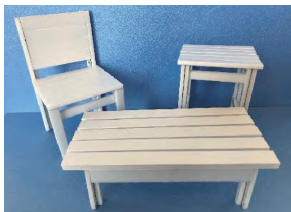
図7-3 スチレンボードによるプロトタイプの一例
