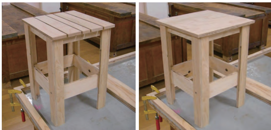
図5-1 合板DL・モジュール木工の基本製作品「直線形スツール」
