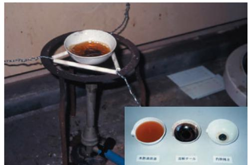
木酢液を加熱して原液に対する残渣の割合を測定する
