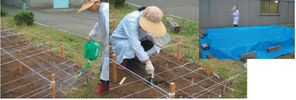
木酢液を散布後、一定期間ごとに土壌を採取して、残留の様子を測定。散布後の雨を避けるために雨除けシートで試験区を被う
