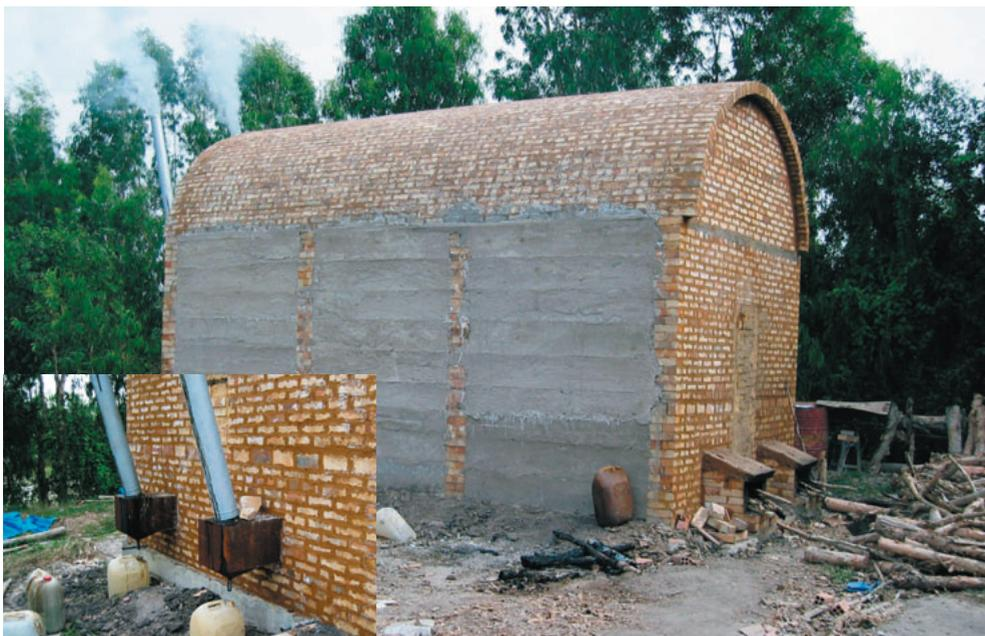
ベトナム式大型炭化炉(左下:炭化炉後方に付けられた煙突と木酢液採取装置)
