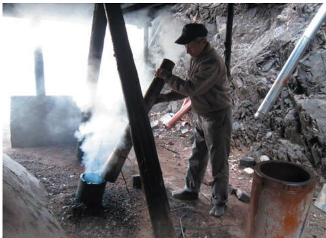
◀ 炭窯後方の排煙口に煙突を設置して木酢液採取の準備
