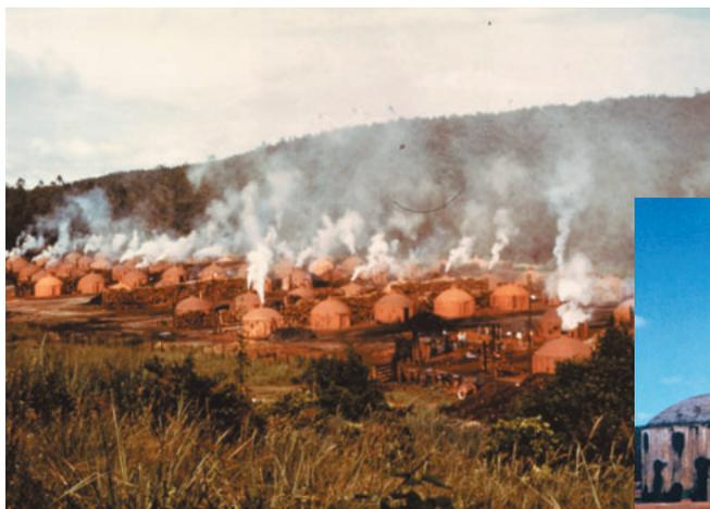
◀▼林立する大型の炭化炉。木炭は製鉄所でコークス代わりに使われる
