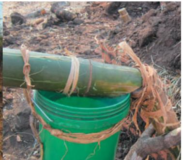
完成したタンザニア式伏せ焼窯と木酢液採取用煙突。煙突で空気冷却され凝縮した木酢液がバケツへ滴り落ちる
