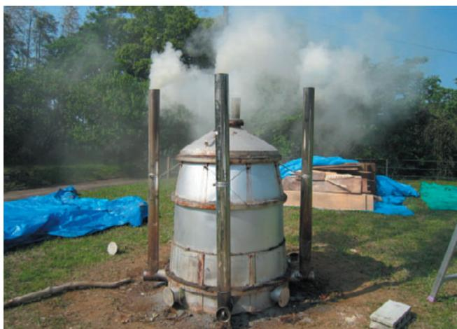
◀炭化炉のふたを被せて煙突から液体(木酢液)を採取する
