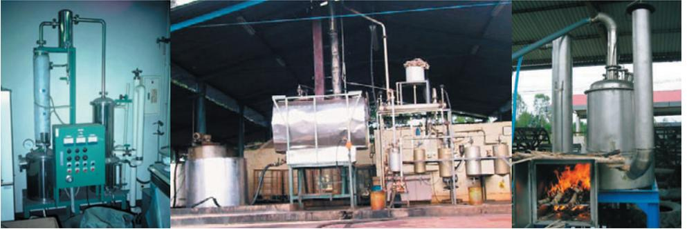
様々な分離精製用蒸留装置(左端は減圧型蒸留装置)
