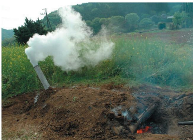
◀勢いよく出る煙・煙突で冷えた煙は凝縮して酢液となって滴り落ちる
