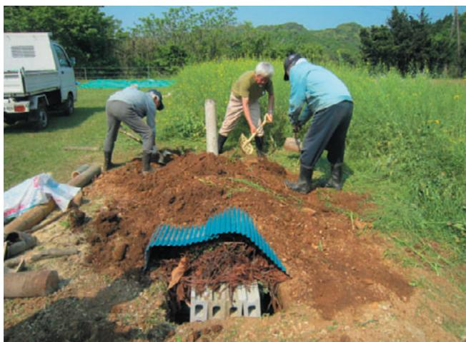
◀炭材を草や枝葉で被い、さらにその上をトタン、土で被って作る伏せ焼きの炭化炉
