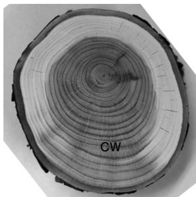
図 1-1-1 傾斜した幹の下側に形成されたイチイ( Taxus cuspidata )の圧縮あて材(CW)
