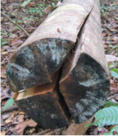
14. 玉切りによって生じた丸太切断面の心裂け(マメ科, *Eperua falcata*、仏領ギアナ、山本浩之氏提供)。伐採や玉切りによって丸太切断面に心割れや心裂けが生じる。このことから、生材樹幹内部には残留応力分布が生じていることがわかる。これによって丸太の製材歩留まりは低下し、潜在的ではあるが大きな経済的損失となっている。一方で、樹幹内残留応力は、樹木にとっては負重力屈性や種に固有の樹形パターンの発現など、樹木が長年月に亘って生命活動を続けてゆく上では、無くてはならない重要な形質となっている。なぜ残留応力分布が生じるのかについては第6章を参照のこと。なお写真では丸太の切断面が黒く汚れているが、これは腐朽ではなく、切断面から分泌された樹脂分のためである。
