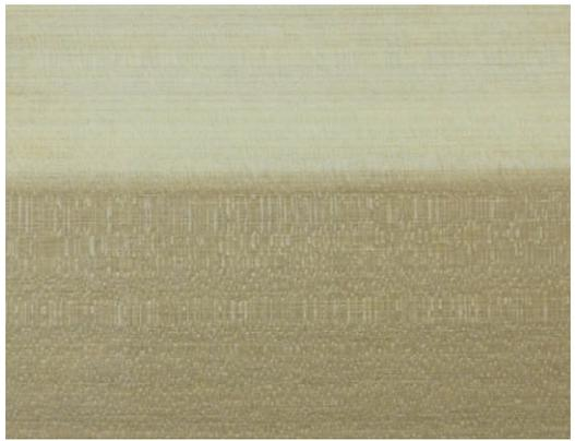
図1 ホオノキの材面(柱目) 軽軟で加工が容易であり、器具材などに使われる
