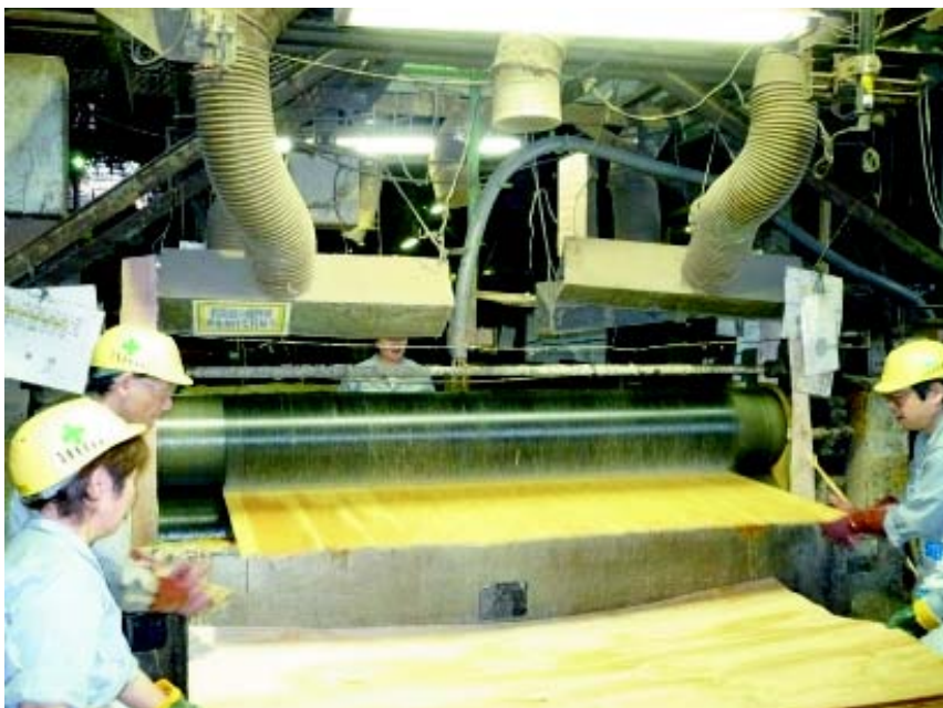
スプレッター（ロールコーター）による接着剤の塗布状況（㈱オーシカ提供）
