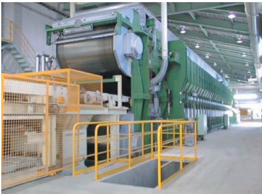
パーティクルボード用連続プレス機（Dieffenbacher 社プレス機、日本ノボパン工業㈱提供）
