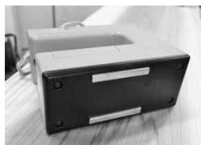
写真3-5 高周波容量式含水率計の平行板状電極
